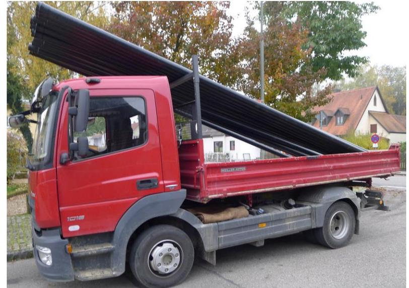
Ladefläche fällt zur Fahrzeugmitte beidseitig ab. Bei 38 Grad 0,8 g Sicherungswirkung
