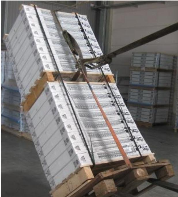
**In Längsrichtung treten die größten Kräfte auf. Wenn eine Ladungseinheit einen rechteckigen Grundriß hat, muß sie so gestaut werden, daß die lange Seite in Fahrtrichtung positioniert wird.**
