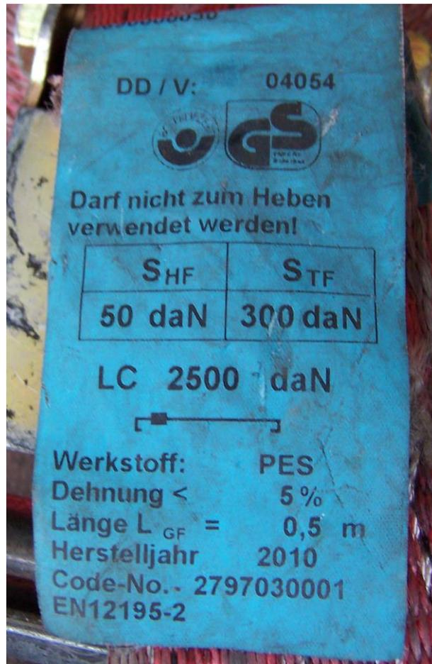
Für eine Niederzurrung wird für die Belastbarkeit  $T_F$  der STF-Wert eingesetzt.
