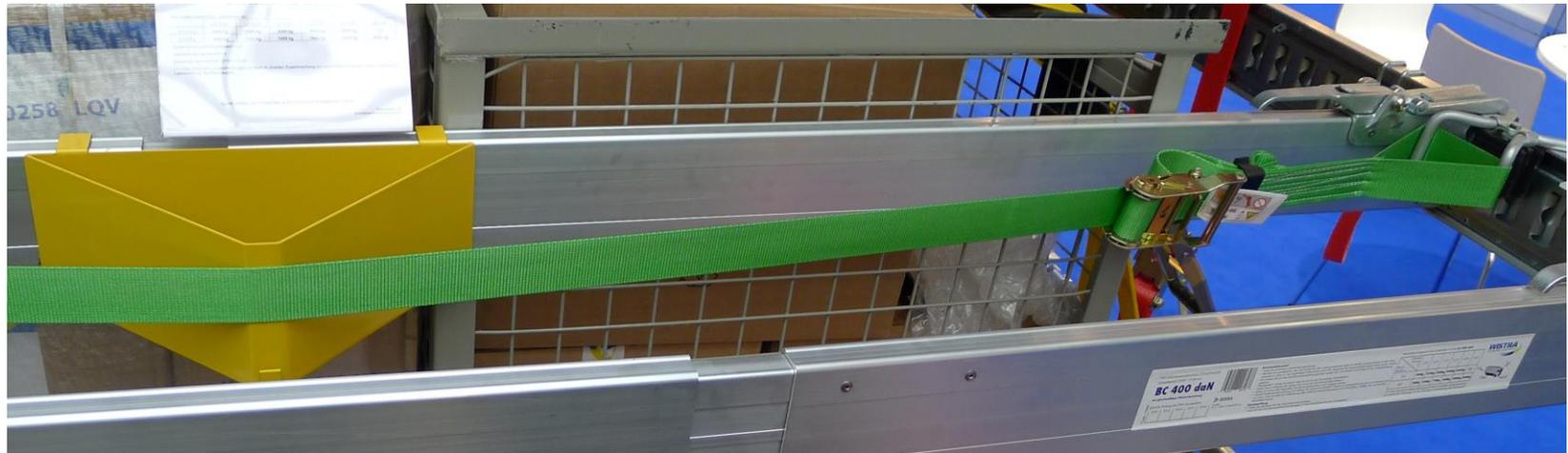
Mit einem Zurrurt und einem Keil wird eine Gegenkraft aufgebracht. Da der „Zurrwinkel“ sehr flach ist, müssen hohe Anzugkräfte aufgebracht werden, damit eine wirksame Gegenkraft in der Mitte über den Keil entsteht.
