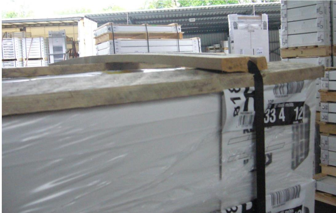
**Feuchtigkeits- und Nässeeinwirkung bei Zwischenlagerung im Freien möglich!**
