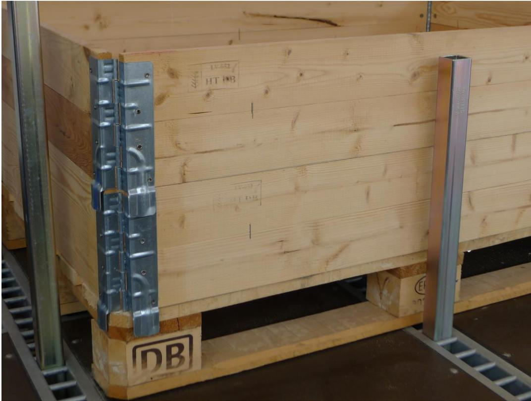
**Formschluß mittels Steckungen in Spezialprofil (in der Ladefläche eingelassen).
