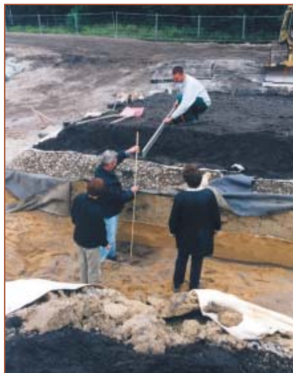
Fremdgutachter bei der Prüfung einer Oberflächenabdichtung, Versuchsfeld Abprodukthalde Terpe, Foto: Archiv TZ
