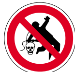
Kleiderreinigung mit Pressluft verboten
