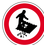
Betreten verboten, Durchsturzgefahr
