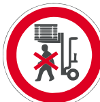
Nicht unter angehobene Last treten
