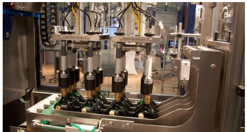
Verarbeitung von Formflaschen Processing of bottles with custom shapes
