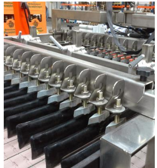
Anordnung der Schlauchgreifer Arrangement of parison gripper
