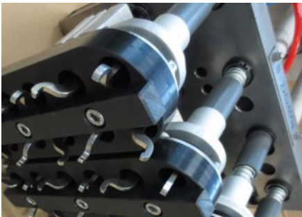
Greiferkopf für Dosen Gripper head for cans
