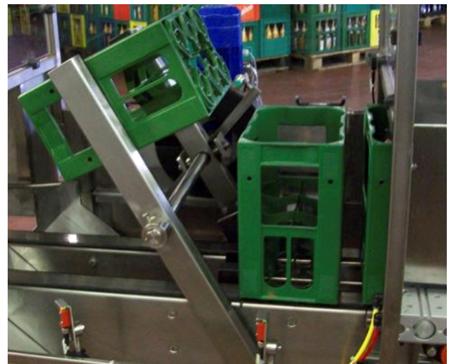
Sichere Kastenklammerung Secure crate clamp
