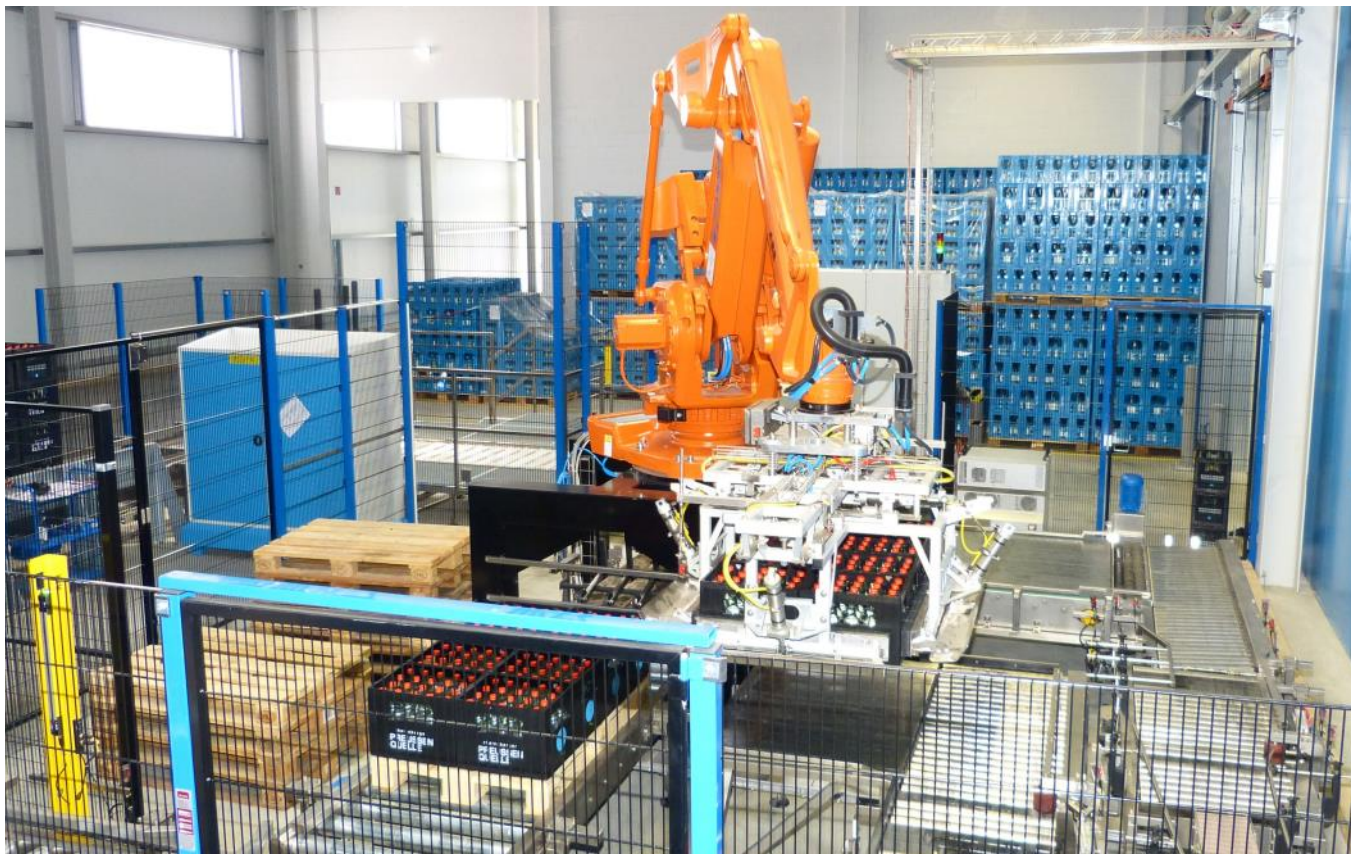
Lagenbepalettierung und Lagenentpalettierung als Roboterlösung Robotic solution for layer palletizing and layer depalletizing
