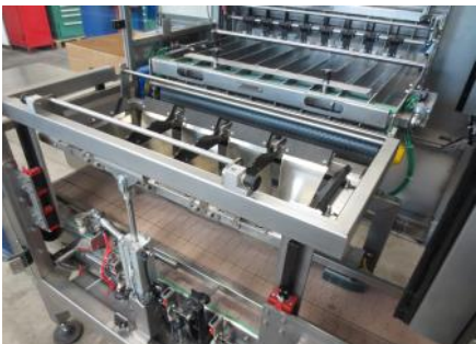
Gesteuerter Zentrierrahmen für Kartonverarbeitung Controlled centring frame for cardboard processing
