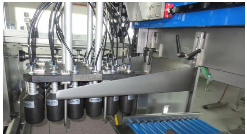
Niederhalter und Packkopf mit Kasten-zentrierung Downholder and packing head with crate centring
