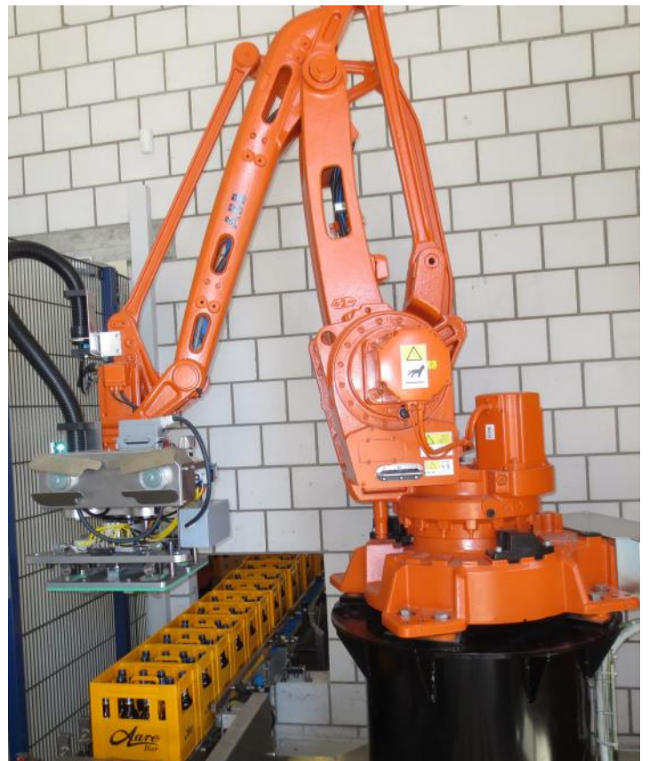
Palletierung von Kästen auf Europaletten Palletizing of crates on Euro pallets
