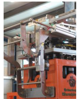
Sichere Kastenklammer Secure crate clamp
