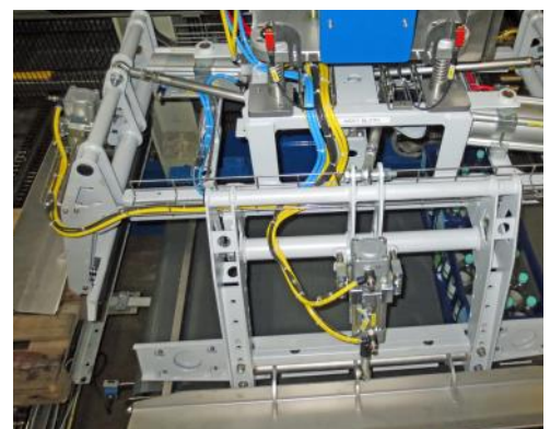
Klemmgreifer für Bepalettierung Clamp gripper for palletizing
