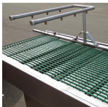
Transport mit Überspritzung Conveyor with water injection on top
