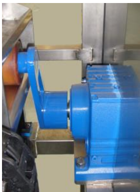
Massiver Antriebsarm Solid Drivearm
