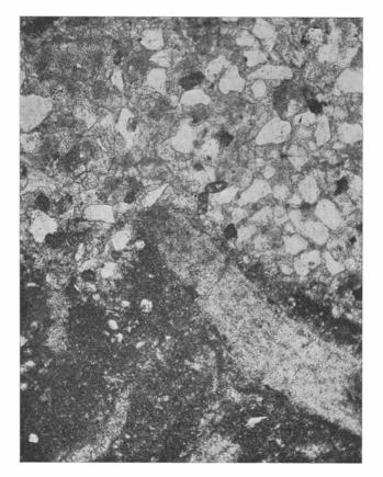
Fig. 50. Calcareous sandstone resting on »fragment limestone». Lower Cambrian. Hardeberga.  $60 \times$ . (Pr. 2782. Pl. 348.)
