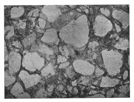
Fig. 75. Calcareous sandstone. Lillråndan, Rånddalen, Härjedalen. (Pr. 570. Pl. 391.) – 60 $\times.$
