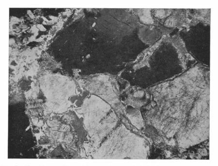
Fig. 82. Vemdal quartzite, white. Klövsjö. (Pr. 766. Pl. 399.) -- 50  $\times.$  Nic.+.
