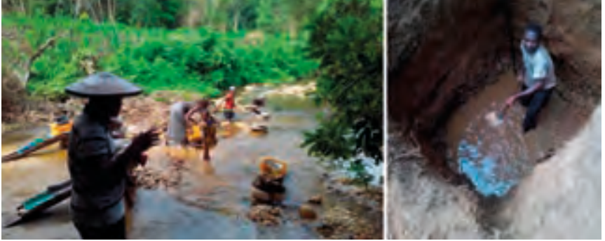
Figure 146 : à gauche : exploitation de l'or alluvionnaire à Idifiou. À droite : exploitation de diamant alluvionnaire à Gbadi Gaodo (Clichés : Konkondji, 2017)
