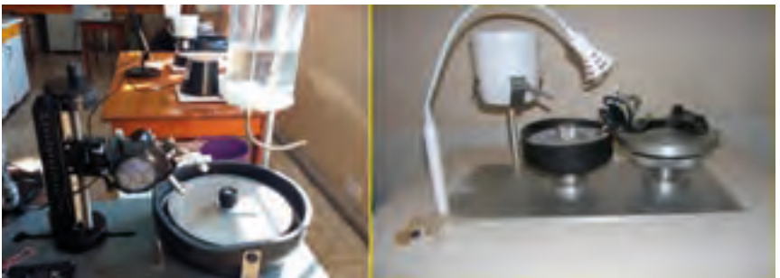
Figure 68 : Deux différents modèles de machines pour le facettage. A droite : modèle Raytech shaw. A gauche : modèle Ultratech. Source : Zo harimalala, 2017.
