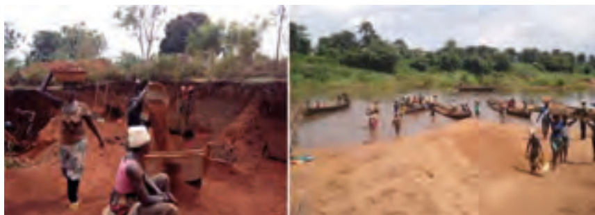
Figure 84 : à gauche : femmes opérant le traitement du tout-venant des graviers roulés par tamisage à Dévé (Commune de Dogbo, Département du Couffo, Bénin). A droite : femmes transportant le matériau sableux vers la berge sur un site d'exploitation artisanale de sable fluvial à Loko-Akankpè (Commune de Zangnanado, Département du Zou, Bénin).
