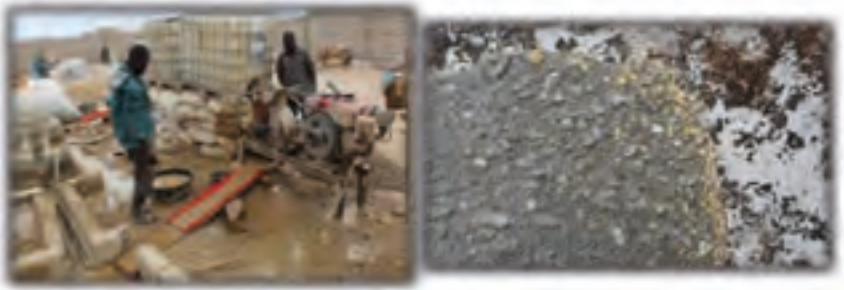
Figure 28 : Sluice amélioré couplé à un moulin (à gauche) et concentré d'or (à droite) obtenu après lavage du minerai (Mauritanie).
