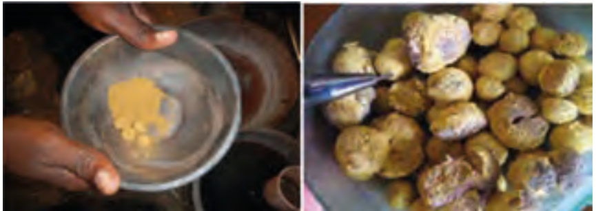
Figure 31 : Or spongieux obtenu après la phase de brûlage de l'amalgame (Centre de Chami).
