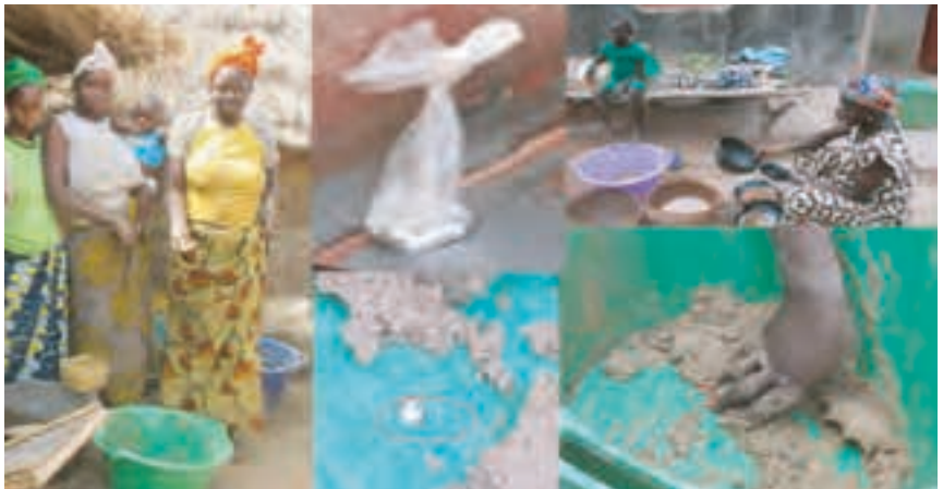
Figure 75 : Utilisation du mercure pour l'amalgamation de l'or.
