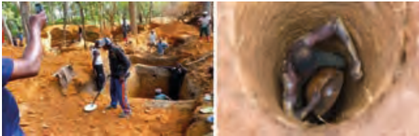
Figure 111 : à gauche : creusage d'un ouvrage rectangulaire et usage du détecteur pour la recherche de pépites d'or à Sala (Siguiri, Guinée). A droite : Creusage d'un ouvrage circulaire à Sala, Siguiri, Guinée.
