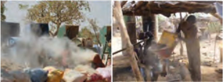
Figure 26 : Emission de poussières durant les phases de broyage et de concassage (sites au Burkina Faso).
