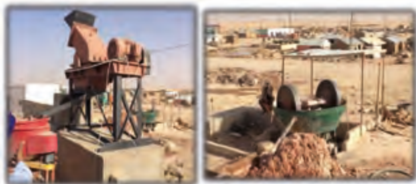
Figure 25 : Types de broyeurs installés au centre de traitement de Chami (Mauritanie).
