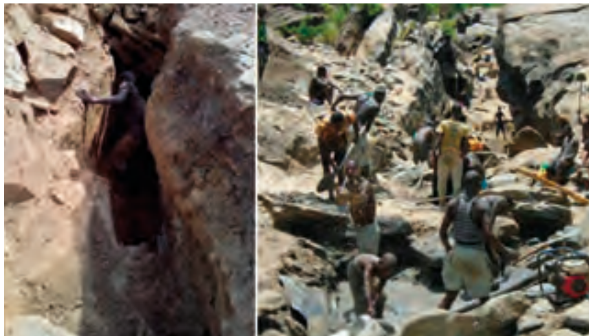
Figure 148 : à gauche : exploitation de l'or filonien à Kparatao. À droite : Exploitation de l'or enchâssé dans les alluvions de remplissage des fractures du lit rocheux de la rivière Na à Kparatao (Cliché : Sogle, 2015).
