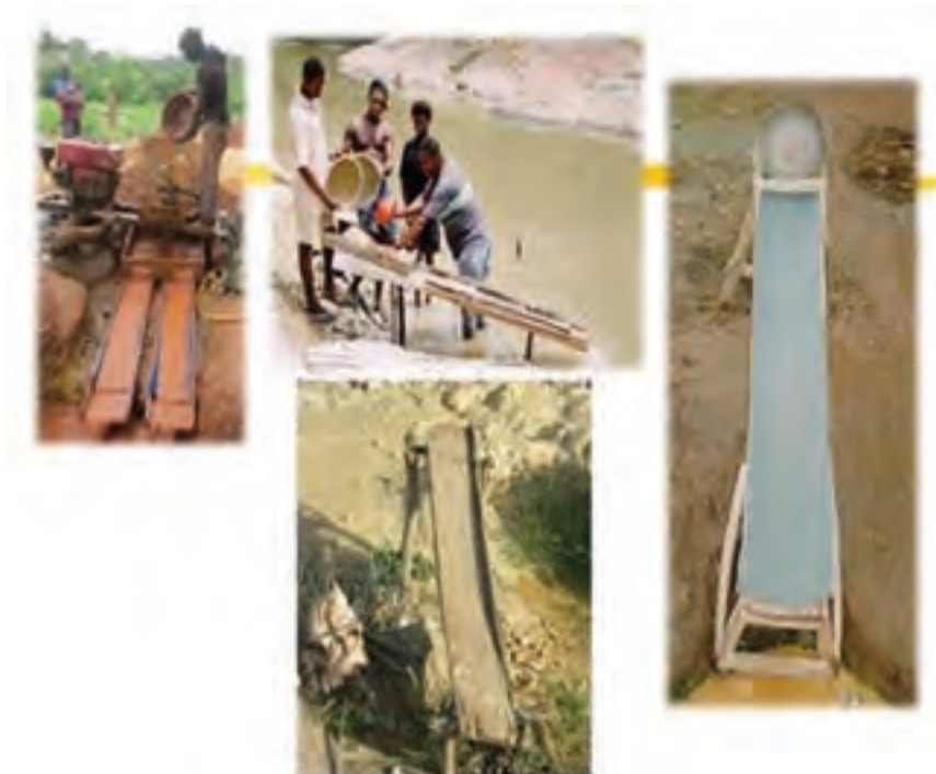
Figure 27 : Sluices artisanaux confectionnés en bois (sites de Kourémalé, Guinée).
