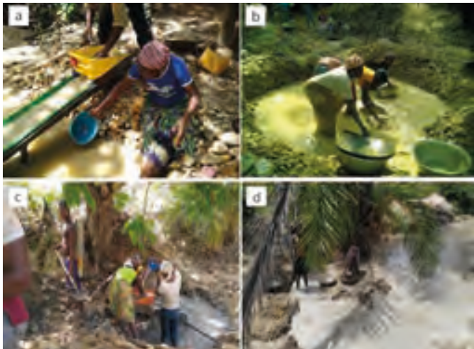
Figure 147 : Lavage du minerai au sluice de fortune à Agbandaoudè (a) (Cliché : Sogle, 2013) et à Kéméni (c) (Cliché : Boutoyi, 2019). Lavage du minerai à la batée à Agbandaoudè (b) (Clichés : Sogle, 2013) et à Agbandi (d) (Cliché : Boutoyi, 2019).
