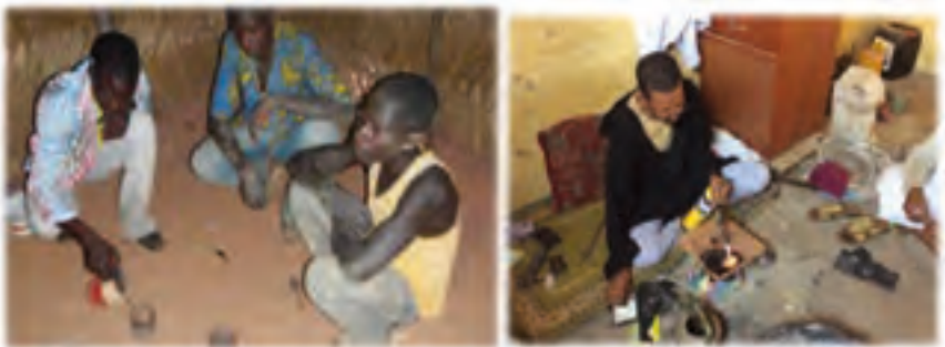
Figure 33 : Brûlage de l'amalgame à l'intérieur d'une hutte (Sites de Bouda, Burkina Faso).
