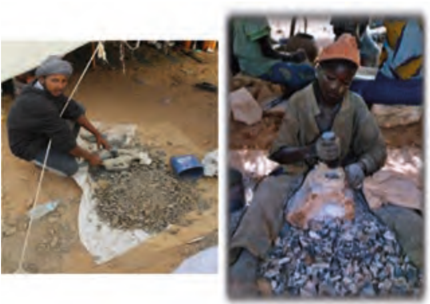
Figure 22 : Concassage au marteau des matériaux extraits des fosses et des galeries (sites du Mali).
