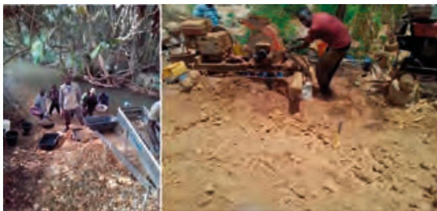
Figure 149 : à gauche : lavage d'alluvions diamantifères au sluice à Gbadi Gaodo (Cliché : Konkondji, 2017). À droite : installation mécanisée pour broyer le minerai à Agbandi-Mono (Cliché : Sogle, 2013).
