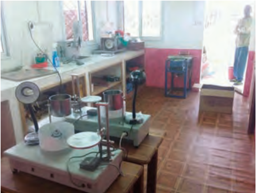
Figure 67 : Atelier de lapidairerie des pierres gemmes sur un site minier à Sakaraha. Source: Tahiry Camara, 2018.
