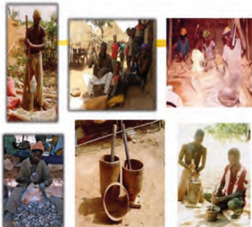
Figure 23 : Phases de concassage et de broyage du minerai avec quelques spécimens d'outils utilisés.
