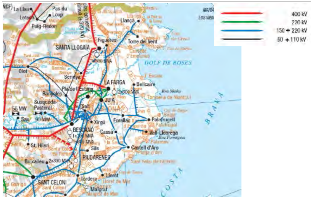
Figura 3. Red de transporte eléctrico en Girona en servicio el 1 de enero de 2015. Fuente: REE.
