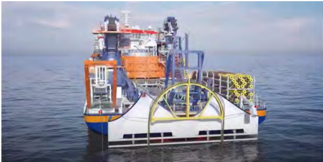
Figura 25. ETC, con detalle del cuadrante realizando el segundo tirado de cable (fuente: SENER).
