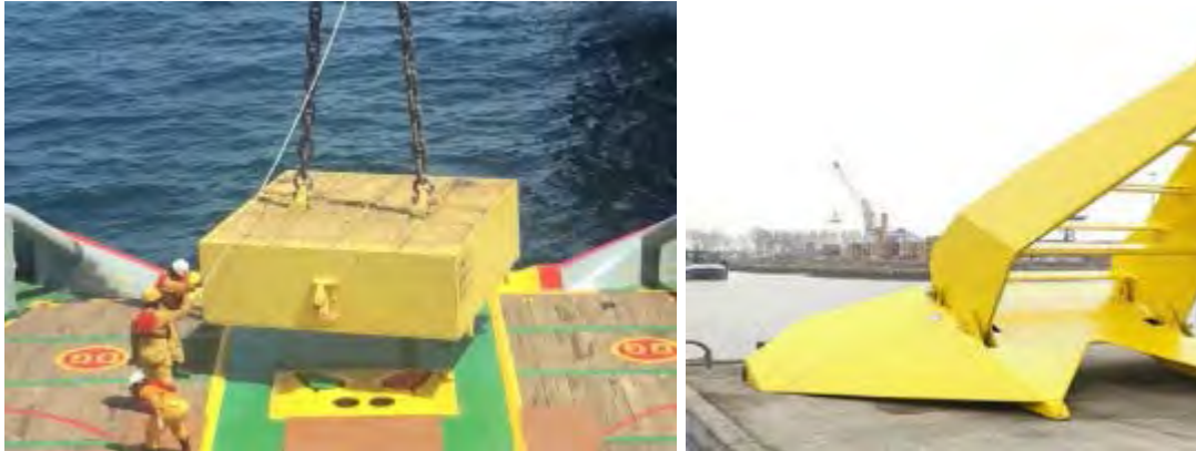
Figura 18. Diferentes tipos de anclas. De izquierda a derecha: ancla de gravedad (Fuente: HHI), ancla de arrastre (Fuente: SMI Offshore)
