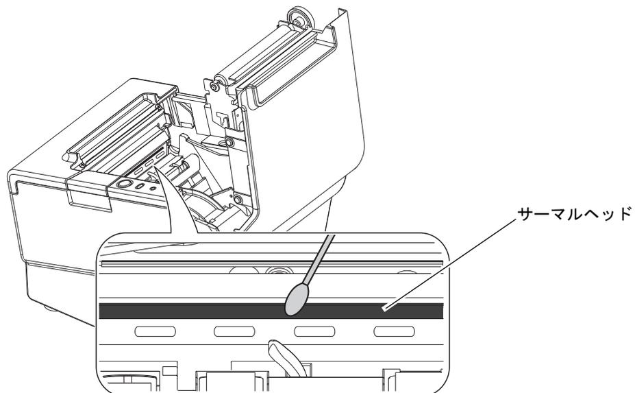
使用するロール紙によっては、紙粉がプラテンローラーやロール紙エンド検出器に付着することがあります。その場合は、軽く水を含ませた綿棒を使用して、プラテンローラーやロール紙エンド検出器に付着した紙粉を除去してください。電源は、水が完全に乾いてから投入してください。
