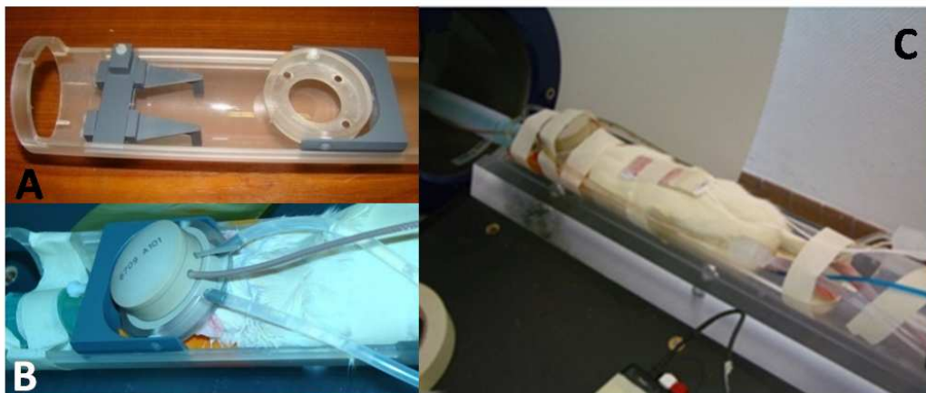
Figure 5.1: Un premier prototype de stéréotaxie du rat et de positionnement du transducteur US (A) a été conçu et fabriqué. Il donne 3 degrés de liberté (2 translations et une rotation). Il permet un positionnement relatif du monoélément sur la tête de l'animal (B et C) avec une précision millimétrique et prévient des mouvements de la tête dus à la respiration.
