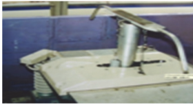
Mauvaise aérodynamique de la base du pantographe
