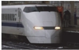
Entraine une déflagration en entrée/sortie de tunnel
