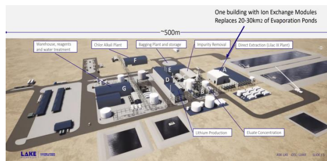
图表 143: 使用 Lilac 直接提锂工艺的生产工厂模拟布局图
