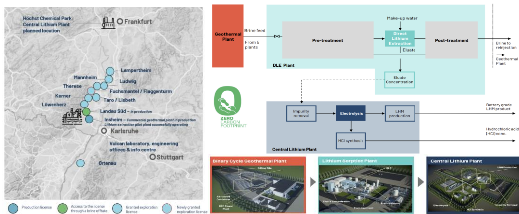
图表 218: Vulcan 将开发地热能源、并从深层地热卤水中吸附提锂、电解生产氢氧化锂，再将尾液注入回地下
