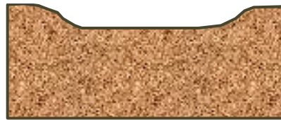
Rebouchage en cuvette
