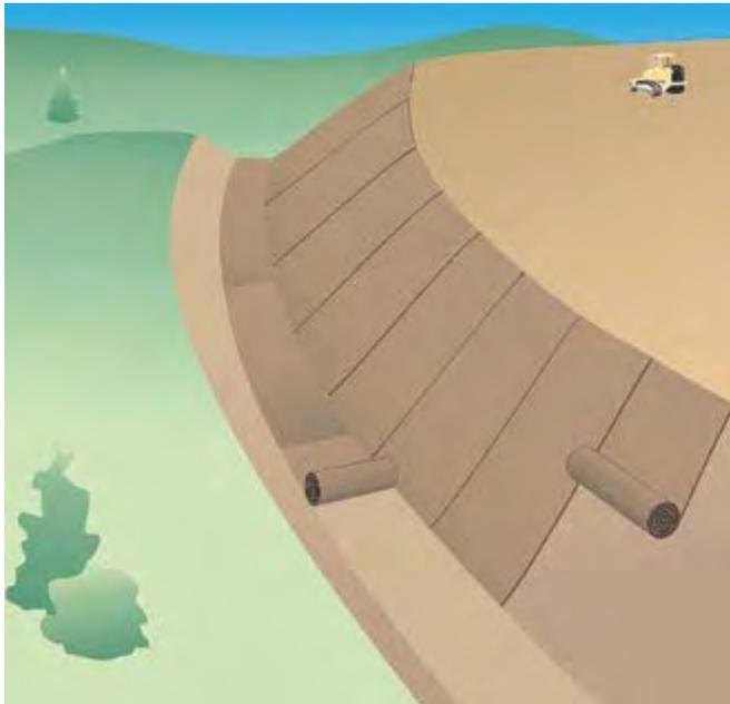
Las pendientes empinadas y grandes necesitan mantas o colchones. Instale mantas y colchones arriba y debajo de las pendientes largas. Para los canales debajo de las pendientes, instalar horizontalmente. No olvidar sembrar, poner cal y fertilizar (de utilizarse) antes de instalar la manta.
