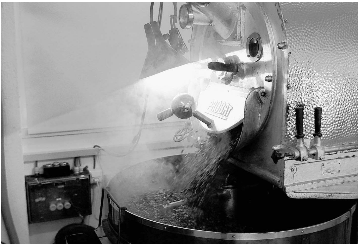
Das Herzstück: Der Röstofen mit Baujahr 1966 spuckt die gerösteten Kaffeebohnen aus.
