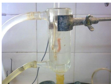
Figura 7: Foto de una cuba termostatzada de doble camisa en cuyo interior se encuentra montado un duodeno aislado de rata el que se encuentra sujeto a un transductor de fuerza. El preparado se encuentra sumergido en solución Tyrode y aireado
