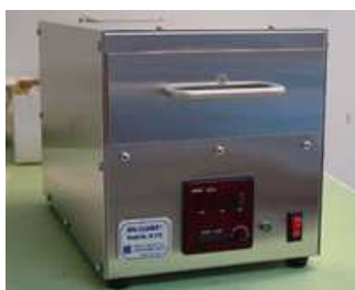
Figure 12. Photographie de l'UV-ozoneur (UVO Cleaner)
