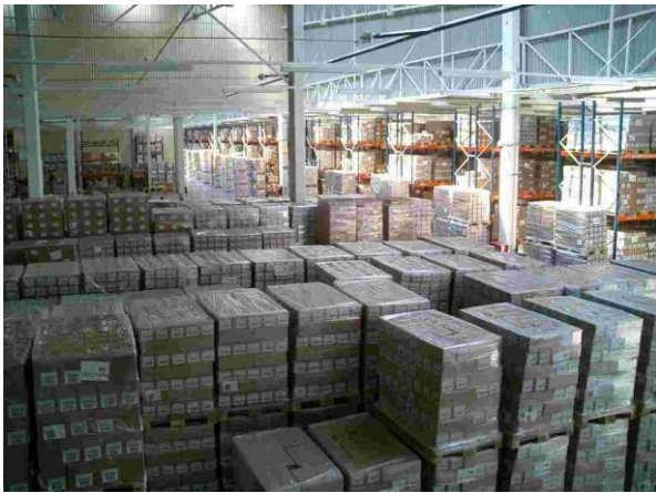
21. ábra Állvány nélküli tárolási rendszer a Kanizsai Gartner-ban
