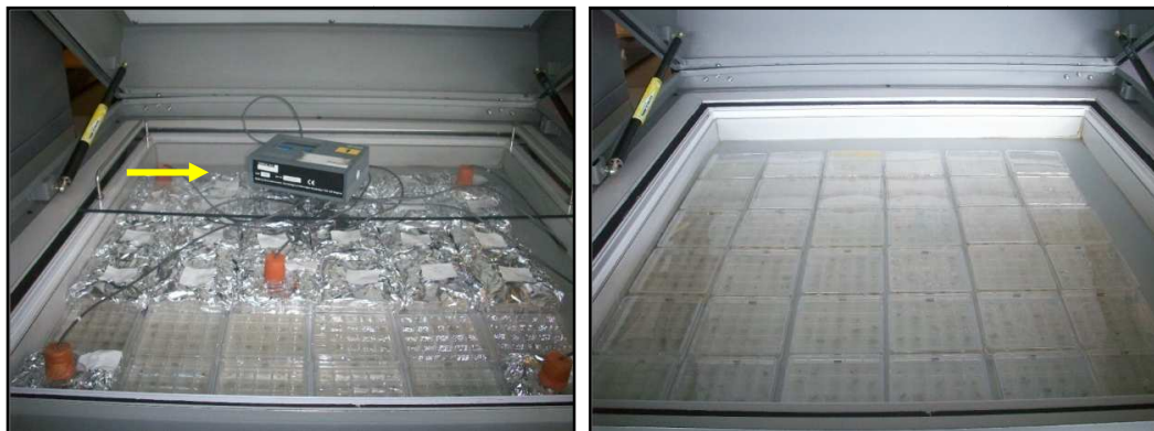
Εικόνα 2.6. Πειραματική διάταξη στην Τράπεζα Διαβαθμισμένων Θερμοκρασιών. Το βέλος δείχνει τον καταγραφέα θερμοκρασίας στον οποίο συνδέονται οι πέντε αισθητήρες.
