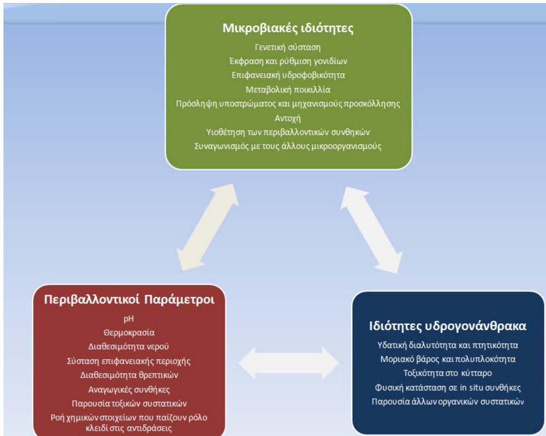
Εικόνα 1.5 Παράγοντες που επηρεάζουν τη βιοαποικοδόμηση. Υπάρχει αλληλεξάρτηση των τριών συνισταμένων (μικροοργανισμός, περιβάλλον και υδρογονάνθρακας) για την κατάλληλη και επιτυχημένη βιοαποικοδόμηση. Πρέπει να λαμβάνονται σοβαρά υπ’ όψιν και οι τρεις παράμετροι για την βιοεξυγίανση των ρυπασμένων περιοχών
