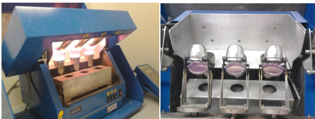
Εικ. 3.9. Δημιουργία υάλων (πέρλες) στην συσκευή CLAISSE FLUXY. Η διαδικασία γίνεται ανά τρία δείγματα, στα Εργαστήρια Ανάπτυξης Ορυκτών και Υλικών της εταιρείας S&B Βιομηχανικά Ορυκτά Α.Ε.
