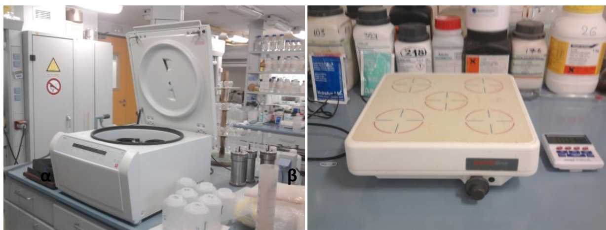
Εικ. 3.10. α) Συσκευή φυγοκέντρισης και β) μαγνητικός αναδευτήρας, όπου πραγματοποιήθηκε η προετοιμασία για τις μετρήσεις των συγκεντρώσεων των διαλυμάτων στον ατομικό απορροφητή, στα Εργαστήρια Ανάπτυξης Ορυκτών και Υλικών της εταιρείας S&B Βιομηχανικά Ορυκτά Α.Ε.
