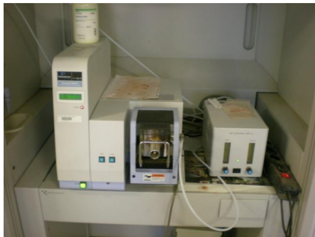
Εικ.3.5. Όργανο TG-DTA, όπου πραγματοποιήθηκαν μετρήσεις στο σύνολο των δειγμάτων, στα Εργαστήρια Ανάπτυξης Ορυκτών και Υλικών της εταιρείας S&B Βιομηχανικά Ορυκτά Α.Ε.
