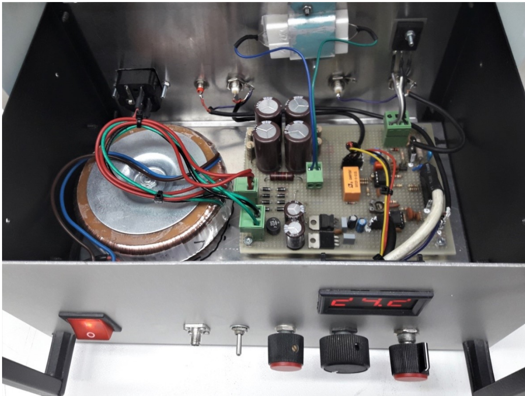
Εικόνα 4.1: Ο οδηγός του πιεζοηλεκτρικού εντατήρα περιλαμβάνει προενισχυτή και βαθυπερατό φίλτρο για την αρχική επεξεργασία του σήματος σφάλματος, το οποίο εισέρχεται από τον ακροδέκτη SMA στην πρόσοψη. Διακρίνεται το τροφοδοτικό υψηλής τάσης και ο μεταβλητός διαιρέτης τάσης που υλοποιείται από τις αντιστάσεις και το MOSFET ισχύος που είναι βιδωμένα στην πίσω όψη του περιβλήματος.
