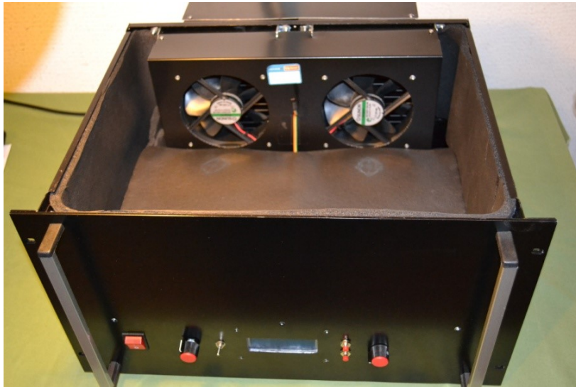
Εικόνα 4.2: Ο θερμικά ελεγχόμενος θάλαμος. Τέσσερα στοιχεία Peltier των 200 W έκαστο είναι τοποθετημένα σε ψυγεία πίσω από τους ανεμιστήρες.
