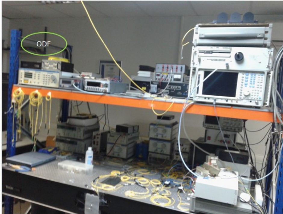
Εικόνα 5.1: Η πειραματική διάταξη για τη μελέτη της ενσωμάτωσης του δέκτη – αναγεννητή TMIL σε εγκατεστημένο δίκτυο οπτικών ινών. Στο βάθος πάνω και αριστερά της εικόνας φαίνεται το πλαίσιο διανομής οπτικών ινών (ODF) του εργαστηρίου.
