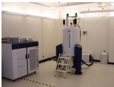
Εικόνα 58. Συσκευή πυρηνικού μαγνητικού συντονισμού NMR Bruker Avance III 600 MHz
