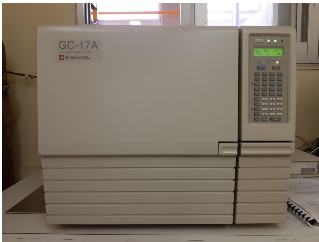
Εικόνα 14: GC-FID (αεριοχρωματογράφος GC-17A, SHIMADZU με ανιχνευτή ιονισμού φλόγας).
