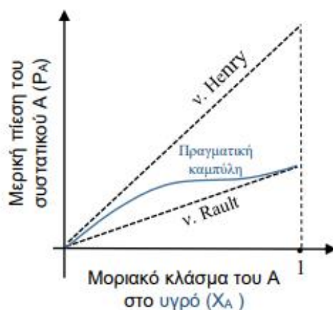
Εικόνα 12: : Για μικρές συγκεντρώσεις επαληθεύεται ο νόμος του Henry και για μεγάλες ο νόμος του Rault.
