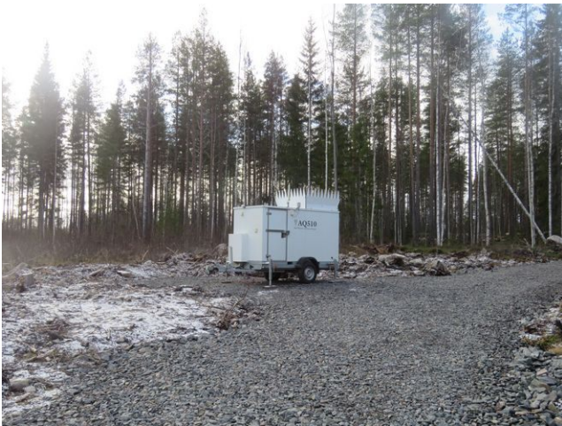
Kuva 13. Doppler-Lidar mittauslaite Lehmikiven Yläharjulla tuulimittaustornin vieressä.
