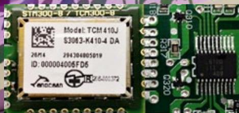
EnOcean-Funkmodul (TCM 410J) integriert in den LED-Leisten. Mikrocomputer mit Dimmer-Output-Funktion von Lapis Semiconductor.
