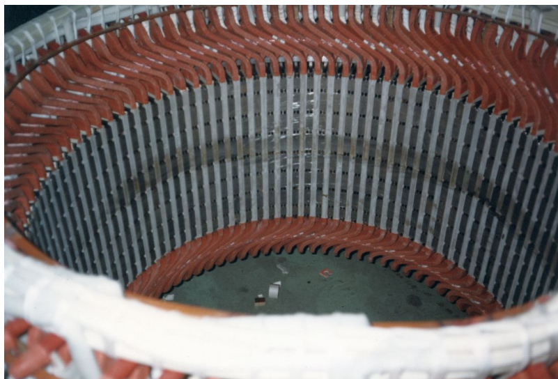
Fig. 11: Devanado de tambor alojado en las ranuras del estator de una máquina síncrona.
