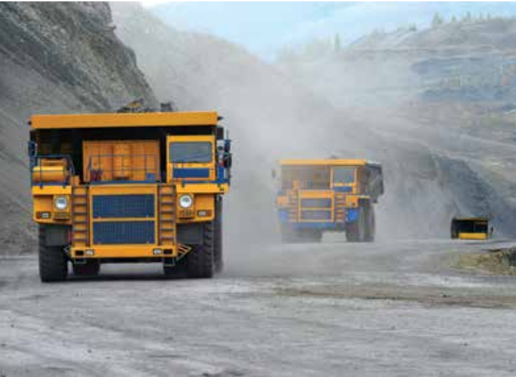
Debido al peso y a la transitabilidad de los camiones de carguío, en los caminos tienden a producirse baches y hundimientos, los cuales resultan perjudiciales pues impactan en la productividad de la máquina, y contribuye al desgaste de los neumáticos.
