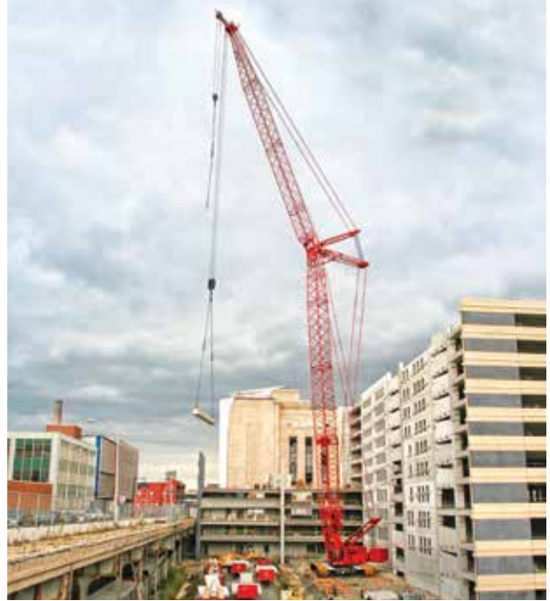
Grúa Manitowoc 16000 cuenta con un sistema de controles independientes electrónicamente (EPIC), lo que permite maniobras más precisas para el operador
