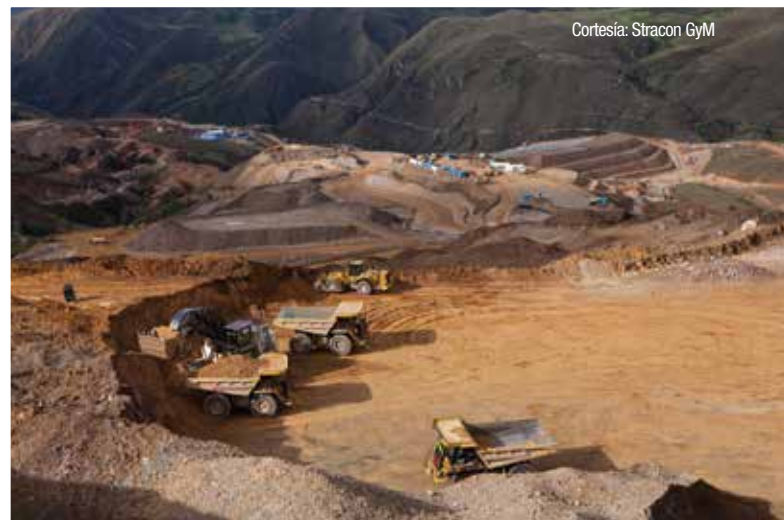
Las vías de acarreo minero para camiones de gran tonelaje deben ser construidas por capas con materiales adecuados cuya capacidad portante resista la máxima presión de la llanta del camión hacia la capa de rodadura.
