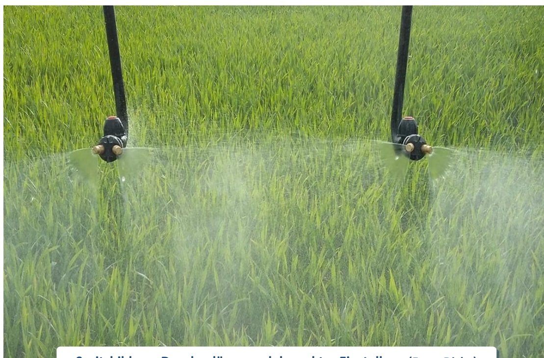
Spritzbild von Droplegdüsen nach korrekter Einstellung (Foto: Dicke)
