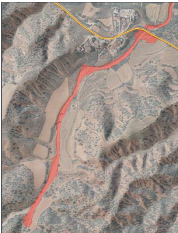
Lámina de inundación de la rambla de Los Marines en su tramo final, para el periodo de retorno T-500 años. Fuente: Ministerio para la Transición Ecológica y el Reto Demográfico
