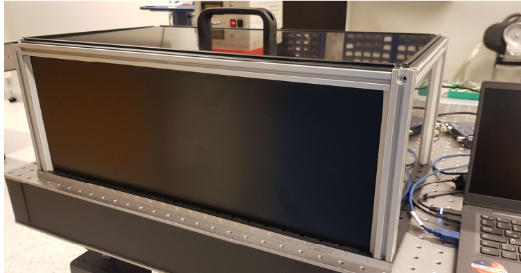
Abbildung 3.2: Der Versuchsaufbau wird gegen Hintergrundlicht abgeschirmt, um so das Signal-zu-Hintergrund-Verhältnis zu verbessern.
