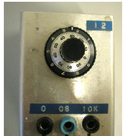
12. ábra: A mikrodiáll 230-ra állítva
