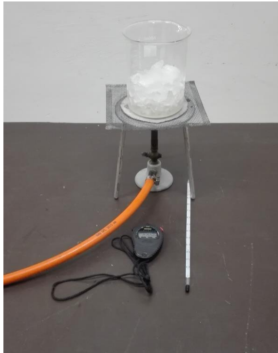
5. ábra: 5 A kísérleti elrendezés részei: főzőpohár jéggel, háromláb vasszitával, Bunsen-égő, hőmérő, stopper.
