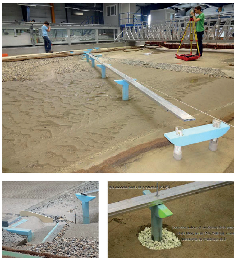
Figure 32 : Modèle physique élaboré pour quantifier les phénomènes d'affouillement dans le cadre des études de projet du viaduc de franchissement de la Durance amont de la Liaison Est-Ouest d'Avignon (Sources : Cerema Méditerranée et CNR Ingénierie)
