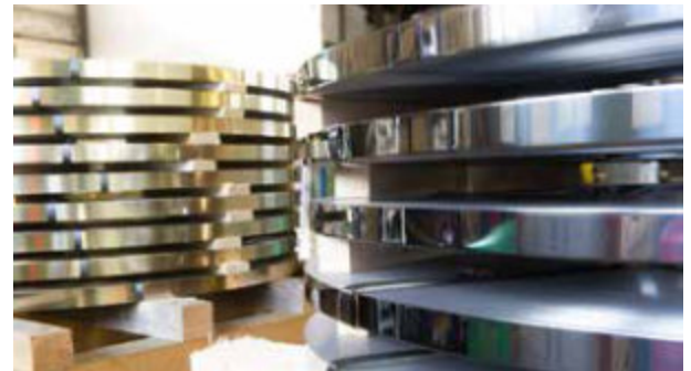
Rohmaterial - Coils mit Messing- und Edelstahlbändern Rawmaterial - coils with brass and stainless steel strips
