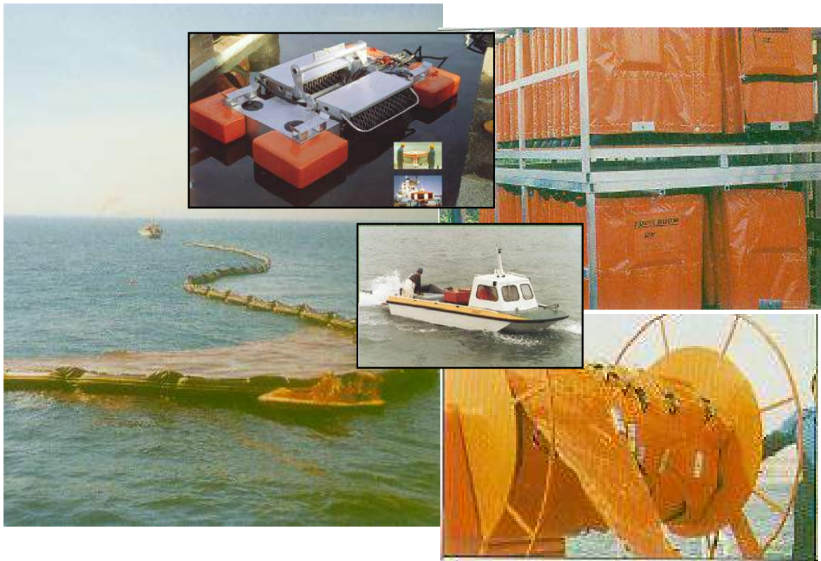
Πλωτό φράγμα περιορισμού ατυχηματικών διαρροών και αποκλεισμού των στομιών που έλκεται από σκάφος βοηθητικών εργασιών
