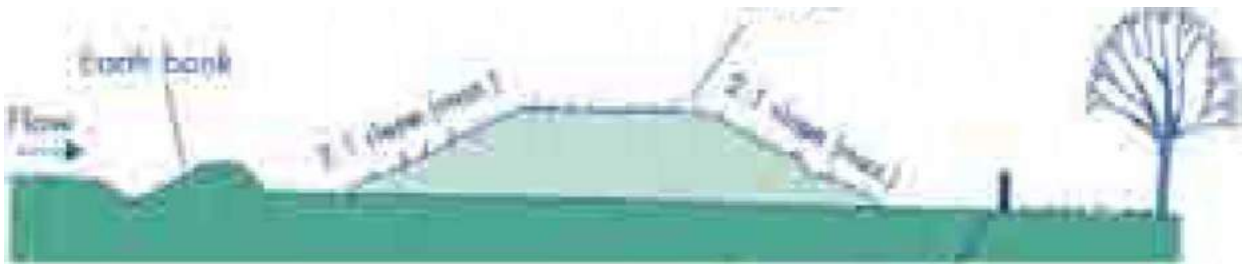
Παράδειγμα διάταξης χώρου αποθήκευσης μπαζών/άμμου
