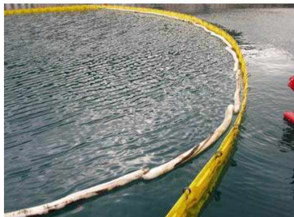
Ενδεικτικού τύπου Απορροφητικό φράγμα
