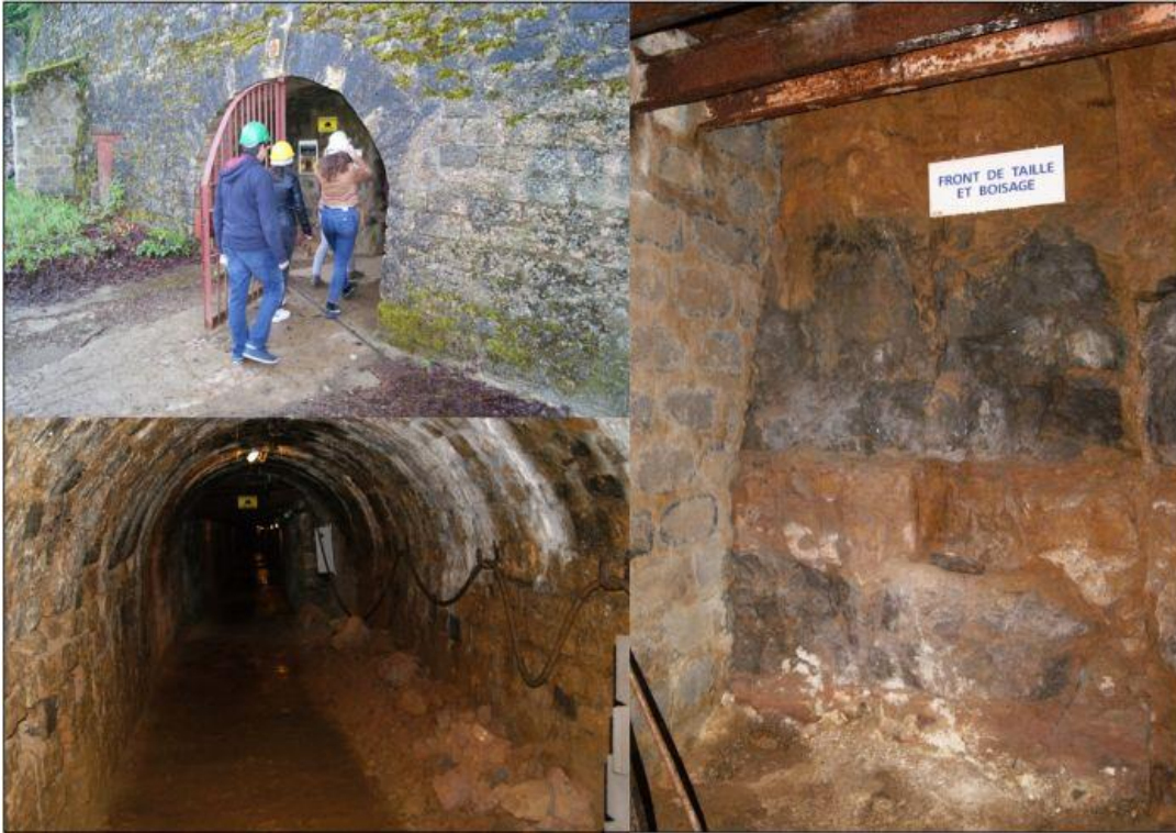
Entrée de mine, la galerie d'entrée en maçonnerie et un ancien front de taille (les couches de minerais apparaissent de couleur rouille alors que les couches de marnes sont grises) © : Roger CHALOT - Didier ZANY
