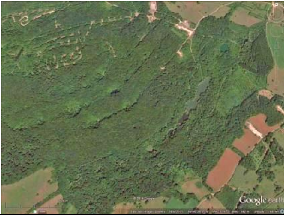
Fig. . Effondrements dus à l'exploitation du sel à Poligny (Jura)
