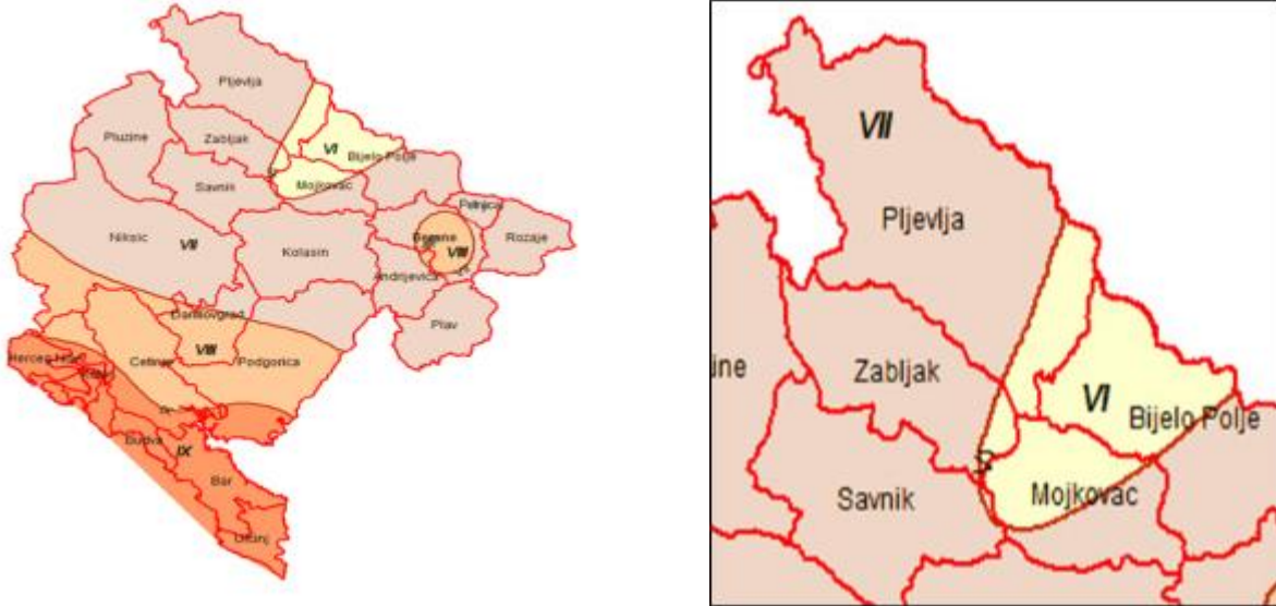
Slika br. 3. Seizmička rejonizacija Crne Gore data parametrom maksimalnog očekivanog intenziteta zemljotresa;
