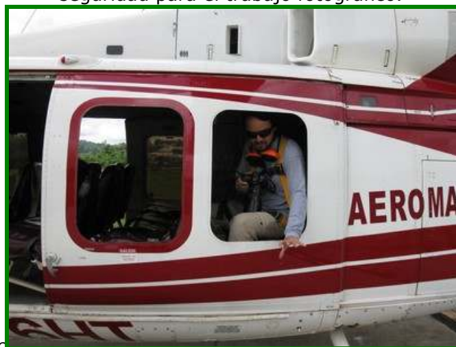
Figura 25. Helicóptero Bell 214 con la extracción de ventanas laterales y arnés de seguridad para el trabajo fotográfico.
