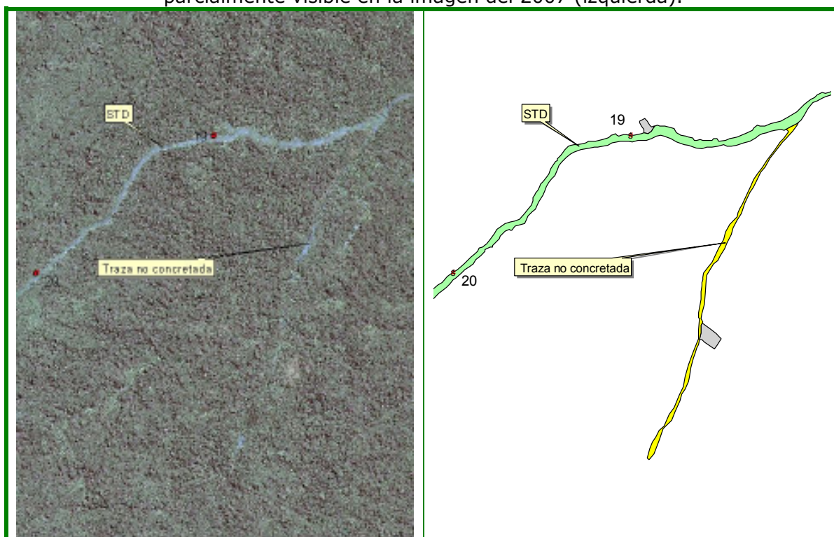
Figura 34. Desbosque sobre traza no concretada entre las progresivas Kp18,5 y 20,5, parcialmente visible en la imagen del 2007 (izquierda).
