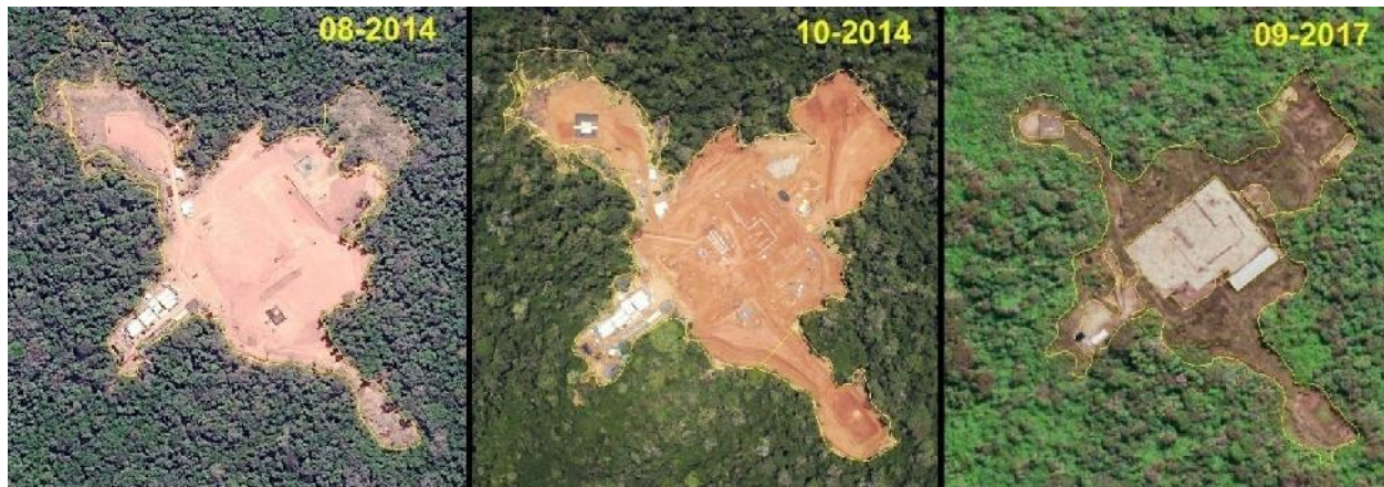
Figura 11: Imágenes Worldview2 y fotografía aérea (centro) de tres momentos de la plataforma Kimaro C. Las dos del 2014 aún en la fase de obras civiles y en el 2017 todavía no abandonada.
