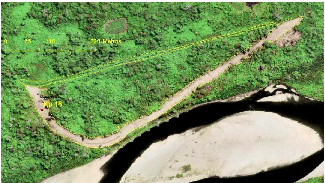
Figura 5: Obras de realineamiento sobre el ducto para alejarlo del margen derecho del río Camisea
