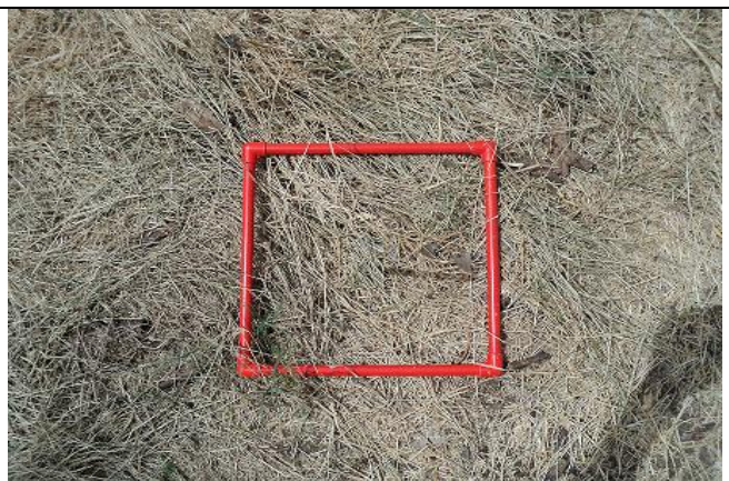
Foto 7. Foto a nadir para vista vertical del suelo a 1m, con cuadro de PVC de 30cm por lado sobre el suelo.
