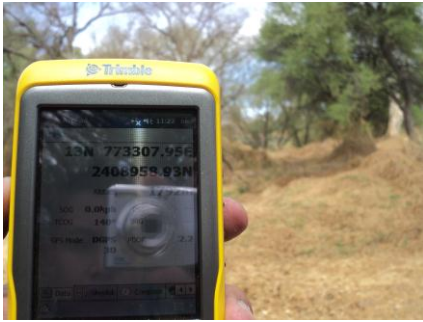
Figura 5.1. Fotografía de la pantalla del GPS, tomada en el centro de la parcela con datos nítidos de coordenadas, UTM y PDOP.
