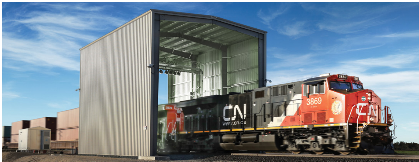
Les portails d'inspection automatisée sont dotés de caméras panoramiques à ultra-haute résolution et d'un éclairage infrarouge qui permettent d'obtenir une vue à 360 degrés du train pendant qu'il y passe à vitesse normale, et de détecter de nombreux défauts invisibles à l'œil nu. Photo du CN
