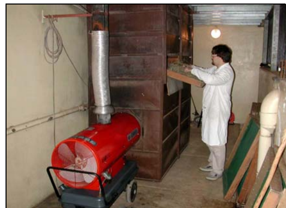
d/ Séchage des collectes en four ventilé à 45^{\circ}\text{C} \pm 5^{\circ}\text{C} (C.N.R.S)
