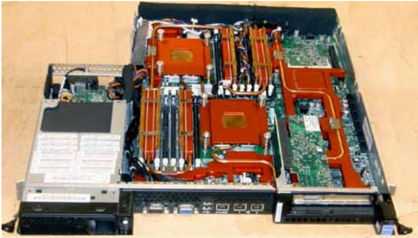
und nach der Umrüstung auf Wasserkühlung
