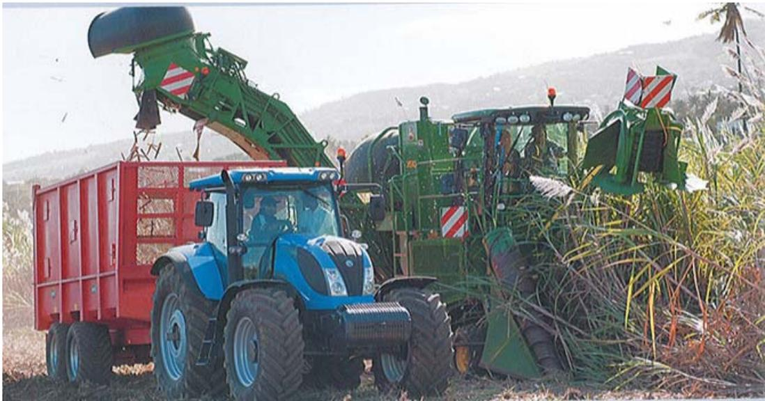
**Ci-dessus : Une coupeuse-tronçonneuse-chargeuse**
