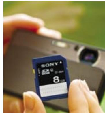
erkennen lässt. Sie eignet sich vor allem für alle speicherhungrigen Anwendungen. Die Expert-Speicherkarten garantieren eine Top-Leistung und bieten eine hohe Datenrate von bis zu 20 Megabyte pro Sekunde. Sie entsprechen der Klasse 10 und sind in den Speichergrößen acht (SF8NX), 16 (SF16NX) und 32 Gigabyte (SF32NX) erhältlich.
