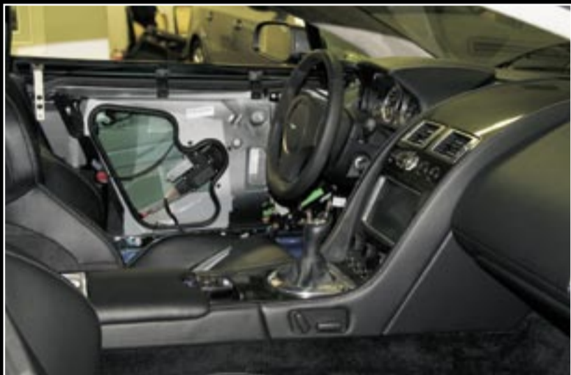
Ein Aston Martin während der Integration eines 5.1-Multimedia-Systems.
