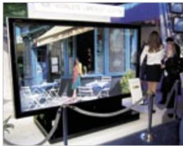
LCD-TV: Bildschirmgröße: 108 Zoll, Abmessungen der Bildfläche: Breite: 2.386 mm, Höhe: 1.344 mm, Diagonale 2738 mm. Bildschirmtreibersystem: TFT Aktive Matrix Treiber. Pixelanzahl: 2,07 Millionen Pixel (4.096 x 2.160 Bildpunkte).
