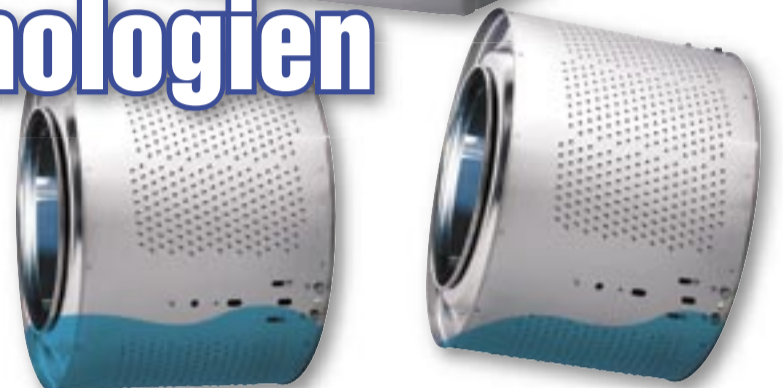
Durch Neigung der Waschtrommel um 10% verringert Panasonic die Höhe des erforderlichen Wasserstands in der Maschine und reduziert den Wasserverbrauch pro Waschvorgang.
