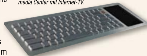
Mit kabellosem Ultra Wideband HDMI und einem Flach-TV wird der Eee Keyboard PC zum Multimedia Center mit Internet-TV.
