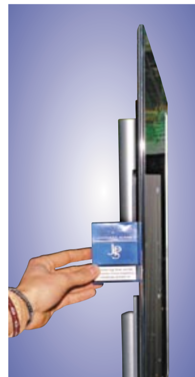
Das Resultat der flachen Panels sind extrem flache Displays, welche nur noch etwa ein Drittel so tief sind wie eine Zigarettenschachtel. Damit kommen die Geräte der Idee vom „Bild an der Wand“ sehr nahe.
