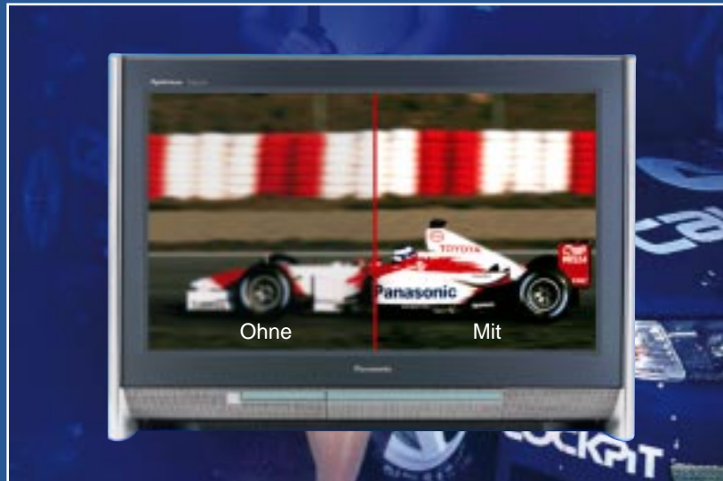
Acuity sorgt für eine perfekte Trennung von Farb- und Helligkeitssignalen und gewährleistet eine harmonische Zusammenarbeit mit dem digitalen Kammfilter. Auch der Nachzieheffekt bei bewegten Bildern wird effektiv reduziert.
