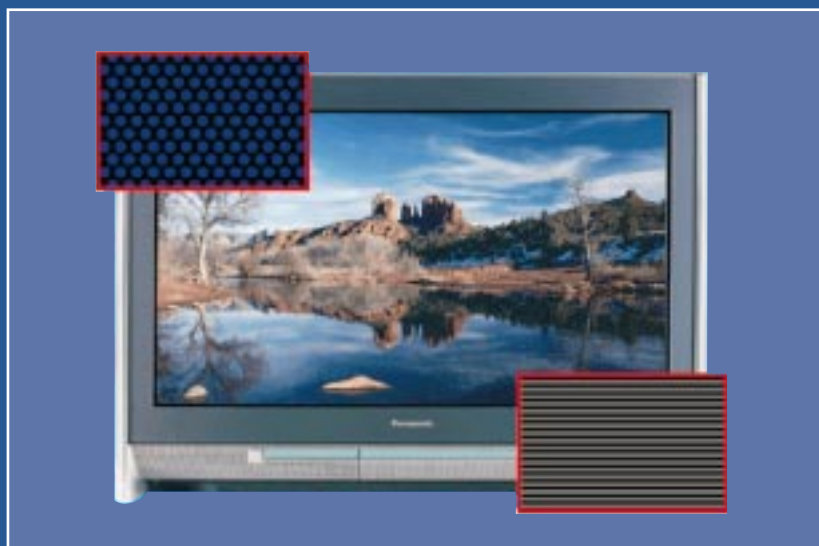
Bilder werden durch horizontale Linien erzeugt. Bei Acuity wird die Anzahl der Zeilen auf 833 erhöht und die Anzahl der Pixel pro Zeile auf 2.300 mehr als verdoppelt. Das Ergebnis ist eine beachtliche Auflösung und eine größere Detailschärfe.
