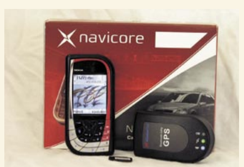
Zu Navicore Personal gehören die Software auf einer Speicherkarte und der GPS-Empfänger; das Handy ist Eigentum des Autors.
